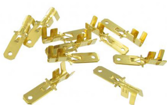
Ongeïsoleerde mannelijke vlakstekkers met weerhaak (10 stuks) Spade connectormaat: 6.3mm, Materiaal dikte: 0.8mm, Draad dikte: 4.0 - 6.0mm 2
