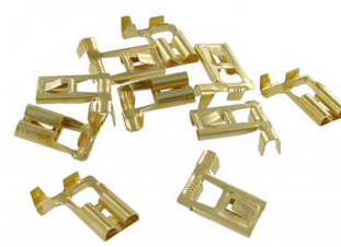
Ongeïsoleerde haakse vrouwelijke vlakstekkers met weerhaak (10 stuks) Spade connectormaat: 8.0mm, Materiaal dikte: 0.8mm, Draad dikte: 1.5- 2.5mm 2
