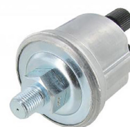
Oliedruksensor met waarschuwings contact Schroefdraadmaat: M10 x 1.0, Druk: 0 - 10 Bar, Spanning: 12V
