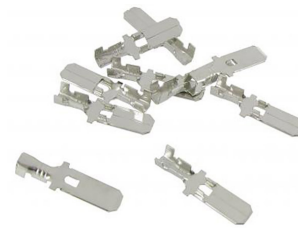
Ongeïsoleerde mannelijke vlakstekkers zonder weerhaak (10 stuks) Spade connectormaat: 6.3mm, Materiaal dikte: 0.8mm, Draad dikte: 1.5 - 2.5mm 2
