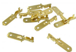
Ongeïsoleerde mannelijke vlakstekkers met weerhaak (10 stuks) Spade connectormaat: 6.3mm, Materiaal dikte: 0.8mm, Draad dikte: 0.5 - 1.0mm 2
