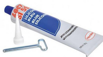
SI 5926 blauwe siliconen pakking Inhoud: 100 ml, Kleur: blauw, Chemische soort: Acetoxy Siliconen, Maximale afdichtingsruimte: 1.0mm, Temperatuurbereik: -54 °C naar +150 °C
