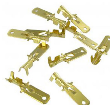
Ongeïsoleerde mannelijke vlakstekkers met weerhaak (10 stuks) Spade connectormaat: 6.3mm, Materiaal dikte: 0.8mm, Draad dikte: 1.5 - 2.5mm 2
