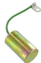
Condensator type-1 motoren 25pk t/m 12.1953, 30pk 8.1960 en later, 34pk t/m 7.1965, type-3 motoren t/m 7.1964
