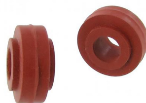
Oliekoeler pakkingen (per paar) type-3 motoren 8.1962 t/m 7.1969
