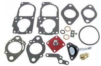
Carburateur revisie / pakking set rechts Solex 32 PDSIT-3, 34 PDSIT-3
