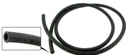
Ontluchtingslang met textiel buitenzijde per meter Binnendiameter: 12mm, Buitendiameter: 17mm, Working pressure: 7 bar, Bursting pressure: 30 bar
