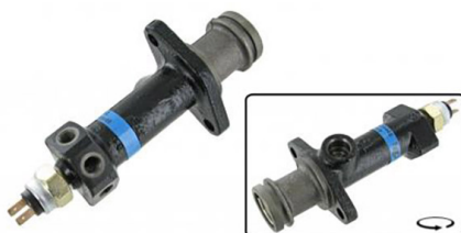
Hoofdremcilinder enkel remsysteem type 3
