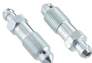
Rem ontluichtingsnippel M10 x 37 (per paar) Bus trommelremmen voorzijde 4.1955 en later, type 3 trommelremmen voorzijde
