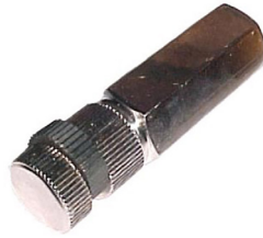
Olievulstukmoer binnen sleutel 8.1960 en later (behalve 30pk enignes)
